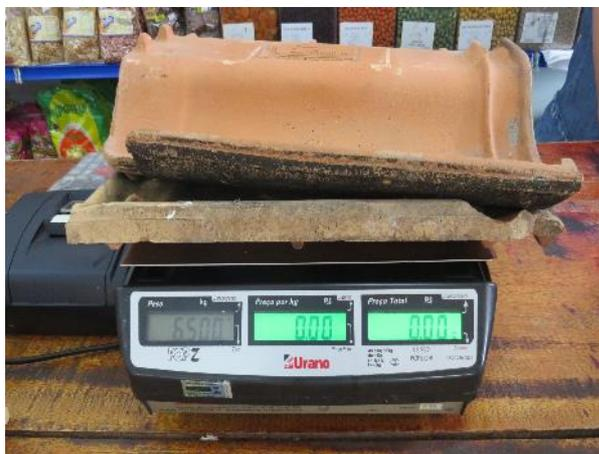
Figura 56 – Telhas submersas para teste de absorção de água
