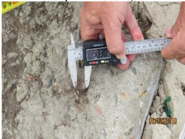
**Figura 32 – Medida do diâmetro do tirante da VP-01-02 (aproximadamente 16,35 mm)**
