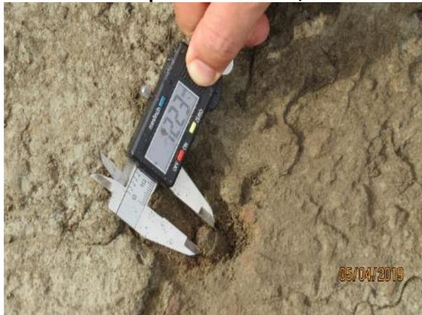
**Figura 30 – Parabol 3, da Figura 27, com diâmetro aproximado de 12,65 mm**
