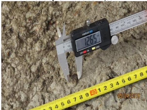
**Figura 31 – Parabol 4, da Figura 27, com diâmetro aproximado de 13,30 mm**
