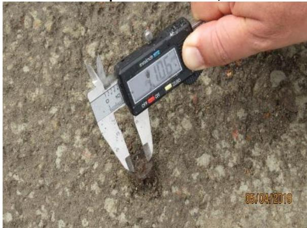
**Figura 29 – Parabol 2, da Figura 27, com diâmetro aproximado de 12,23 mm**
