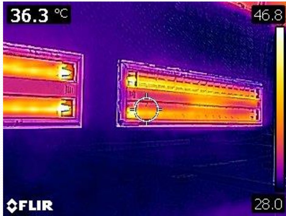
Imagem de câmera termográfica da parte inferior da Marquise Fonte: O Autor (2020)
